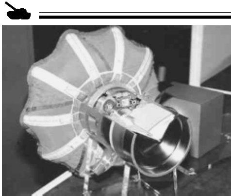
Рис. 3. Боевой элемент точного прицеливания снаряда SMArt 155
